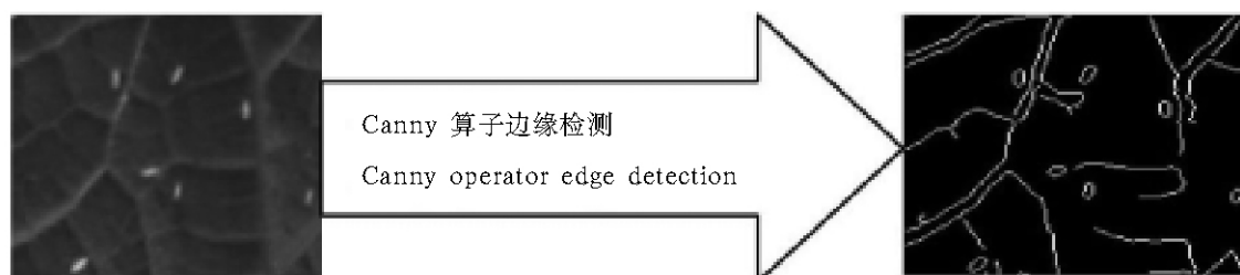
图3 采用 Canny 算子检测目标体及类目标体边缘的示意图
