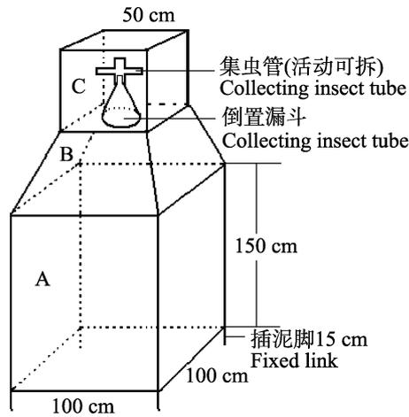
图 2 笼罩结构示意图
