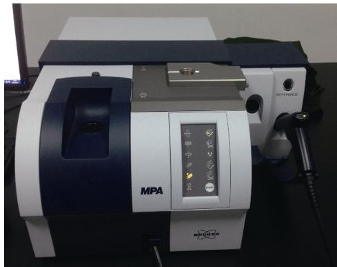
图 1 MPA型多用途傅立叶变换近红外分析仪
