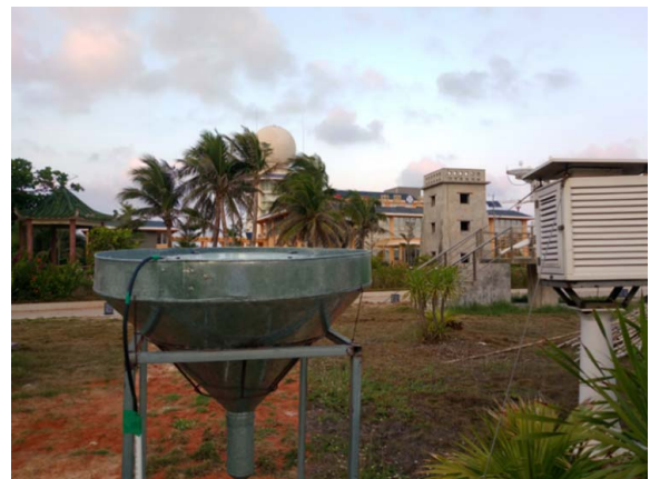
图 1 永兴岛高空诱虫灯实物图 Fig. 1 Vertical search-light trap on Yongxing Island
