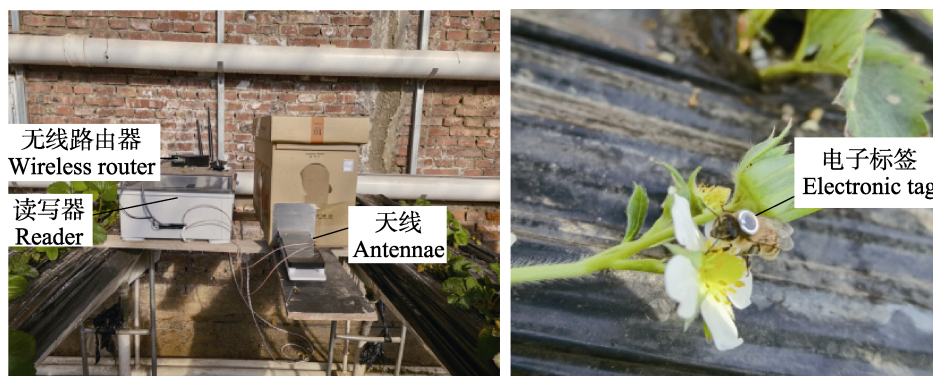
图 1 蜜蜂 RFID 监测系统
