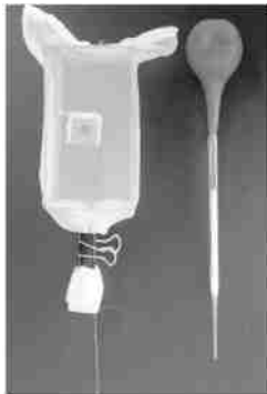
图 4 纱虫笼及吸虫器成品图
