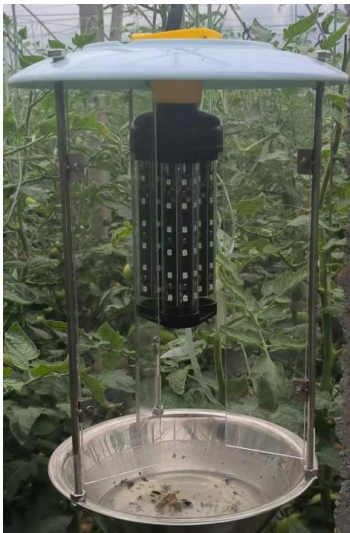
图 2 灯光诱捕器 Fig. 2 Light trap
